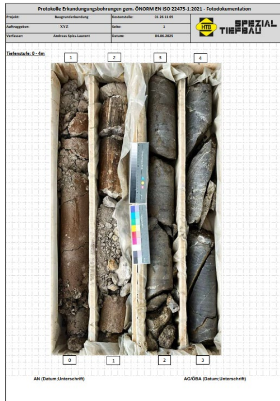
Abb.4 und 5: Bohrprotokoll und Kerndokumentation
