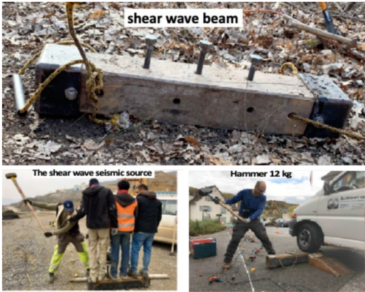
Abb. 3: Anregung von s-Wellen durch Schläge mit einem 12 kg Hammer an den mit Stahlkappen versehenen Scherwellenbalken. Dessen Unterseite ist zur besseren Haftung am Boden mit Winkelisen bestückt. Auf asphaltiertem Untergrund dient als Fixierlast ein schwereres Motorfahrzeug mit einer Auf-fahrrampe auf den Balken.
